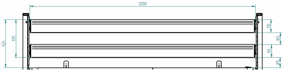
Doorlopend zijhek in twee delen met 115 mm brede spijlen (Artikelnr. 309)
