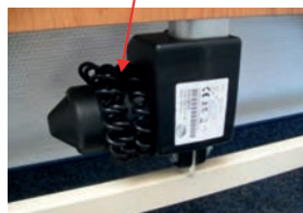
Kabel van de hoog-/laagmotoren loshalen!
